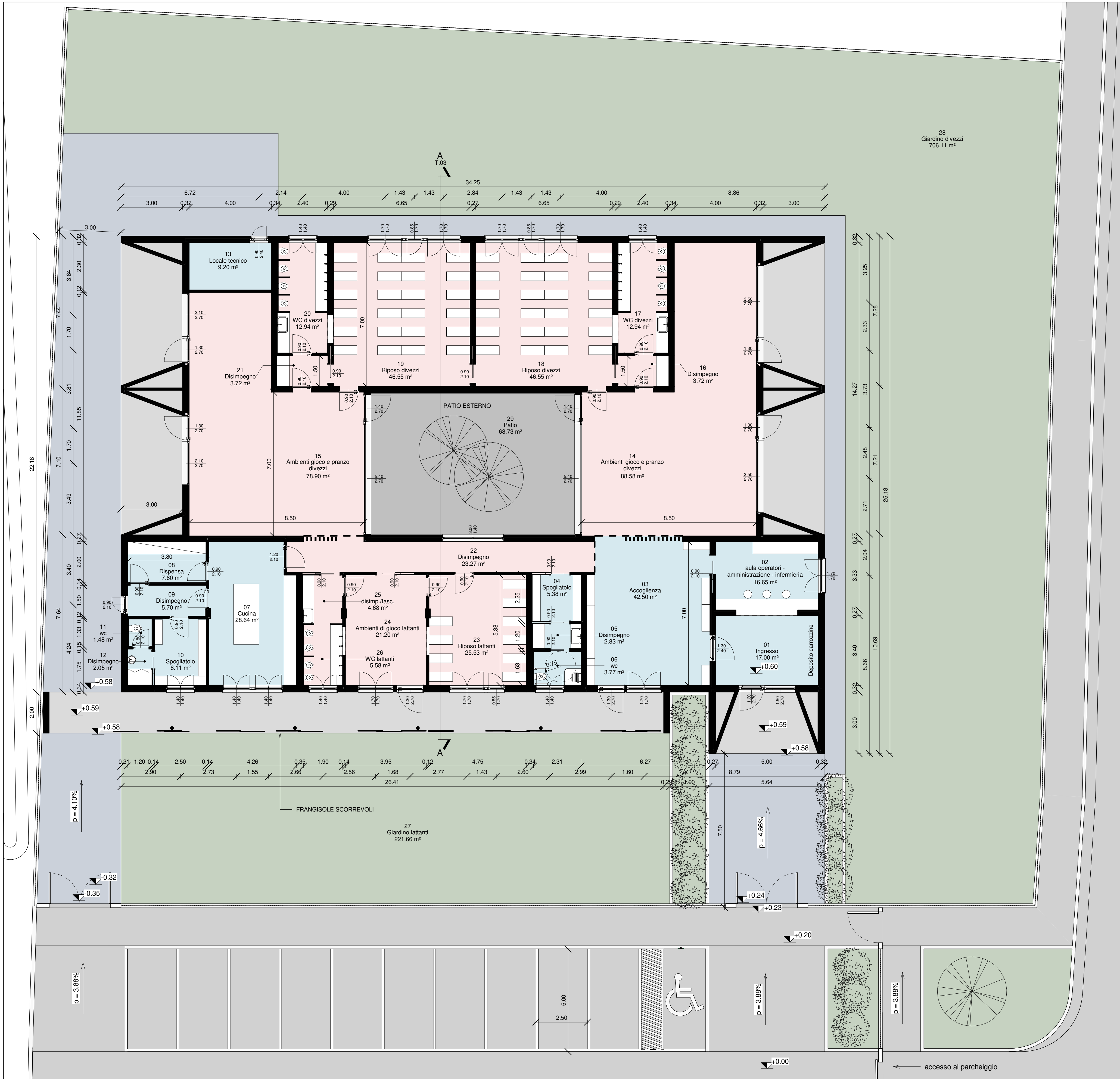
PLANIMETRIA GENERALE DI PROGETTO CON INDICAZIONE DELLE SPECIFICHE FUNZIONI DEGLI SPAZI INTERNI DEL NUOVO ASILO NIDO (SCALA 1:100)
